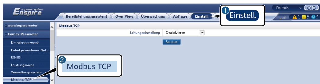
Abbildung 6-32 Einstellen von Modbus-TCP-Parametern
