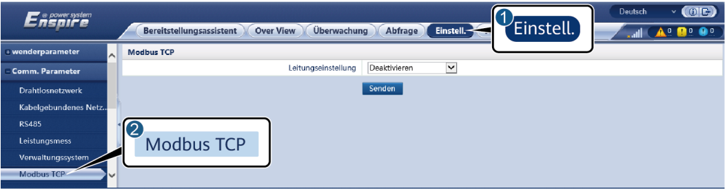
Abbildung 6-39 Einstellen von Modbus-TCP-Parametern
